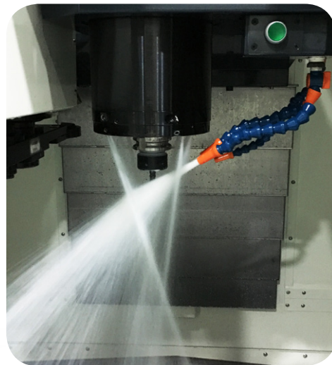
Innere Kühlmittelzufuhr (30 bar)(Optional)
