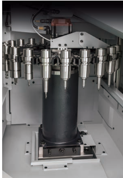
Werkzeugmagazin mit 21 Plätzen (Standard)
